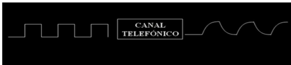
**Fig. 8.8: Distorsion cusada por canal telefónico**
