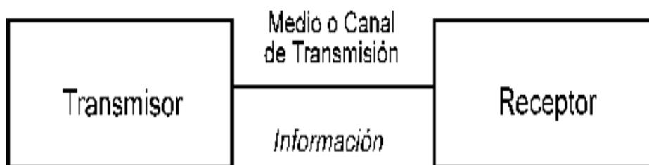
Figura 2.1 Elementos básicos de un sistema de comunicaciones
