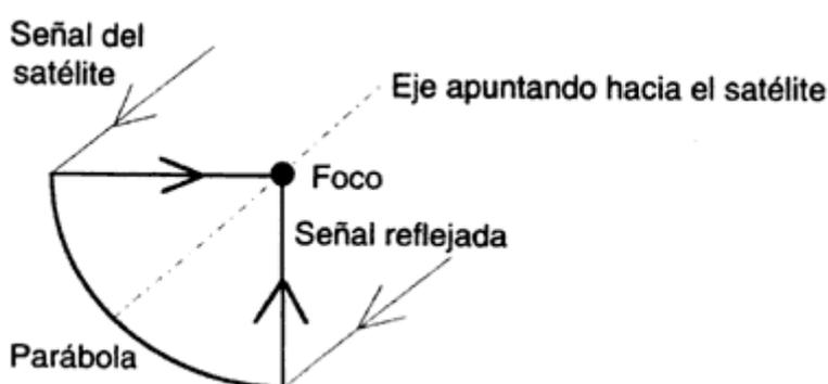
**Fig. 13.10: Operación de una antena parabólica.**
