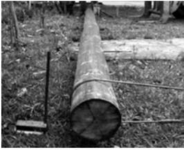
Ensaio de flexão em estaca.
