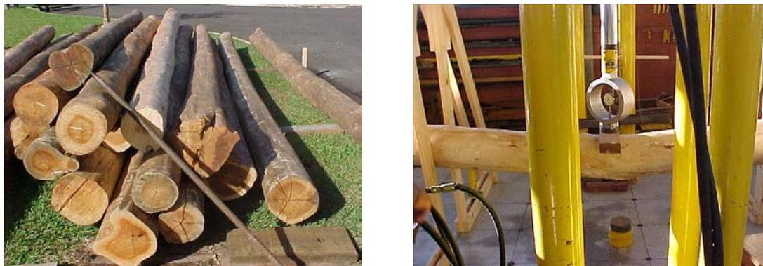
Figura 2.24: Ensaio de flexão com peças roliças c/ Eucalipto Citriodora:  $L = 6,01\text{ m}$  e  $d_m = 26,4\text{ cm}$ . Modo de ruptura: fratura fibrosa “dúctil”, no centro da viga. Fonte: CALIL (2007).
