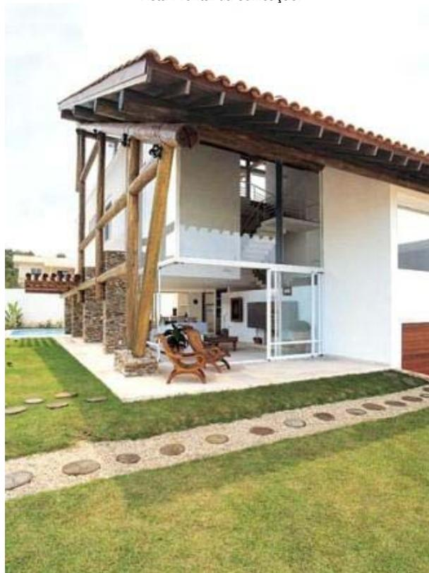
Para construir o mirante na cobertura da residência, a estrutura frontal da edificação foi construída com pórticos de madeira roliça. Esse desenho de cobertura disfarça a altura de 12 m.
