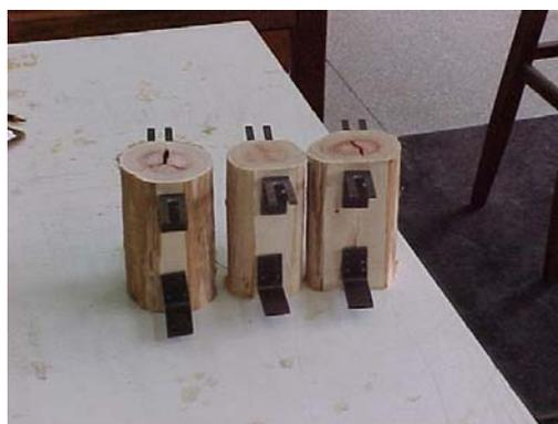
b) Corpos de prova: Modos de ruptura.
