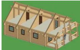
Perspectiva 1: Estrutura das paredes, vigas e colunas.
