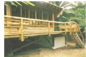
Piso Elevado, internamente em assoalho e externamente em deck sobre vigamentos principais e secundários em Eucalipto roliço (ligações utilizando cavilhas e parafusos).
