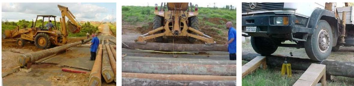
Figura 2.25: Ensaios das peças roliças c/ Eucalipto Citriodora:  $L_m = 11,4$  m e  $d_m = 34,3$  cm. Fonte: CALIL (2007).
