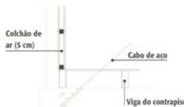
Paredes com duas placas de OSB, tipo sanduíche, dispostas a 5 cm de distância.
