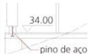
Detalhe executivo: as colunas de madeira são engastadas na laje de concreto por um inserte metálico (pino de aço).
