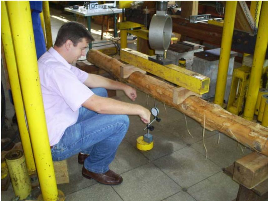
Figura 2.22: Ensaio estático de flexão com relógios comparadores de deslocamentos. Fonte: LaMEM. Fonte: Ensaio realizado no LaMEM em 2008, BRITO (2010).
