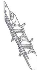
Detalhes da conexão da diagonal.
