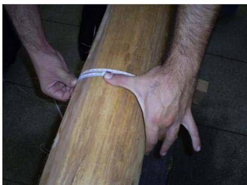
Figura 6.9: Medida do perímetro externo com utilização de uma fita métrica flexível. Fonte: BRITO (2010).
