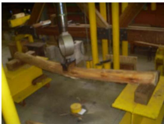
Figura 2.27: Ensaio estático à flexão com peças roliças de Eucalipto Camaldulensis (ensaio com anel dinamométrico e relógio comparador). Fonte: Fotos tiradas pelo autor, em ensaios realizados no LaMEM.
