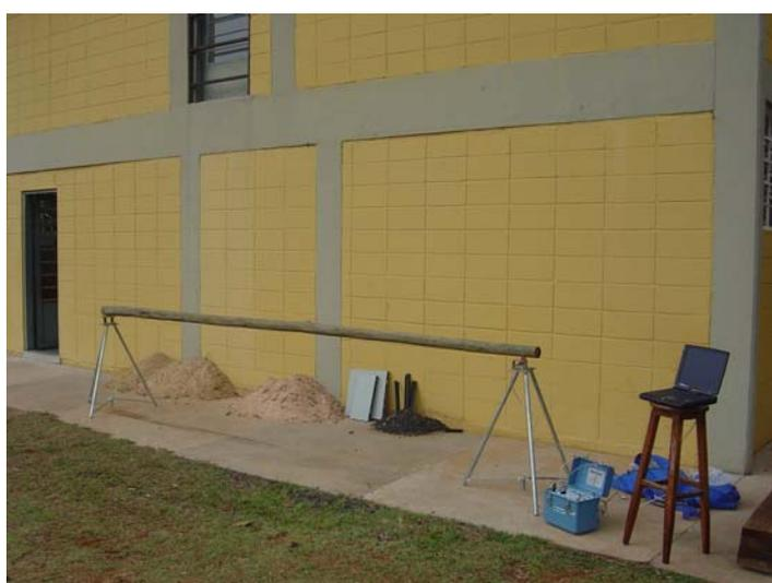
Figura 2.18: Ensaio de Peças Roliças pela Técnica da Vibração Transversal. Peças simplesmente apoiadas em Tripés. Fonte: Ensaio realizado no LaMEM, CALIL (2007).
