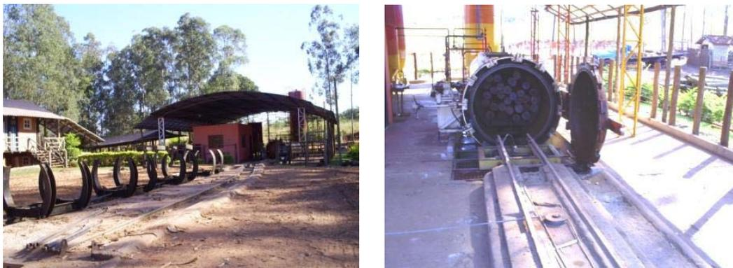
Figura 3.4: Usina de Preservação de Madeira, tratamento de impregnação de preservativo em autoclave. Fonte: Fotos tiradas em visita técnica à usina Petras, em julho de 2008, BRITO (2010).
