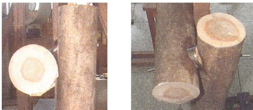
Figura 4.38: Modo de falha por flexão do pino metálico. Fonte: PARTEL (1999).
